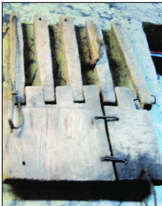
Приспособление для узорного ткачества «на пяти подножках».
